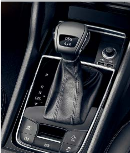
Управляется DSG так же, как и обычный автомат: все те же положения рычага с очень эффективным спортивным режимом.
