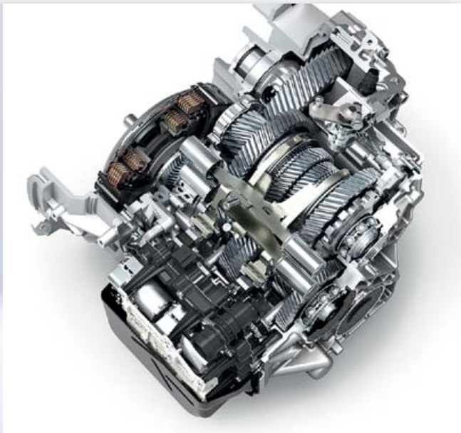
DQ500 (слева) и DQ381 — новое поколение 7-ступенчатых коробок. Они используются на внедорожнике ŠKODA Kodiaq. Запас прочности позволяет.
