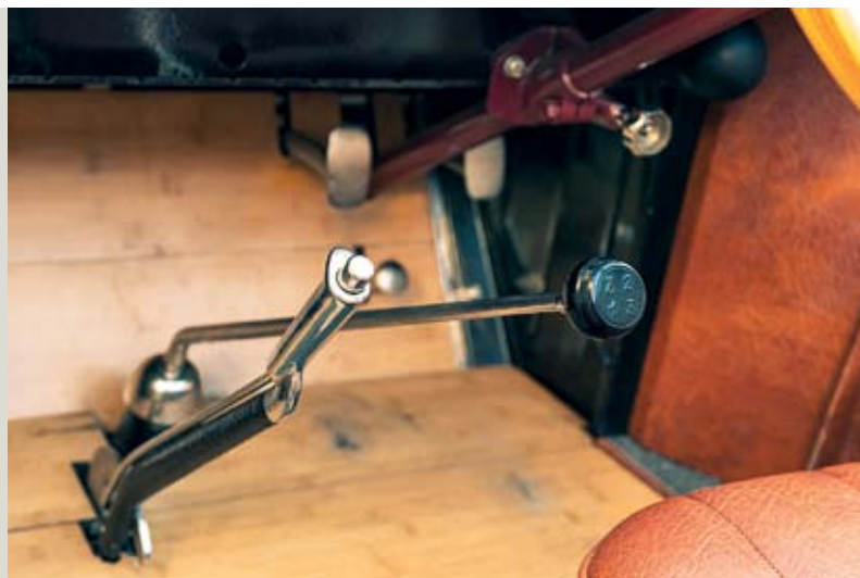
Рычаг трехступенчатой коробки передач для удобства водителя изогнут в его сторону. Под педалями сцепления и тормоза — маленькая кнопка, газ.
