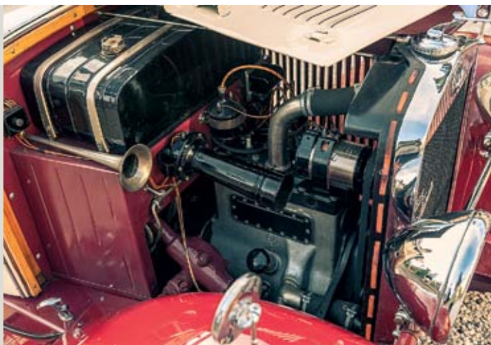
Бензобак расположен под капотом, бензин к карбюратору поступает без насоса, самотеком.
