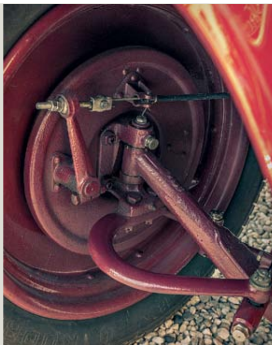
Тросового привода тормозов с регулировкой обычной гайкой для скоростей, которые способна была развить 422-я, вполне хватало.
