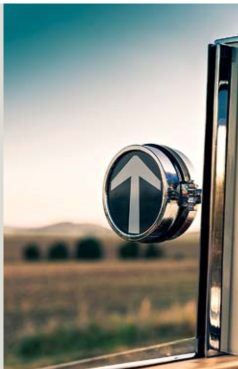
Редкое для начала 1930-х устройство: стрелка, поворачиваясь, указывает направление поворота.
