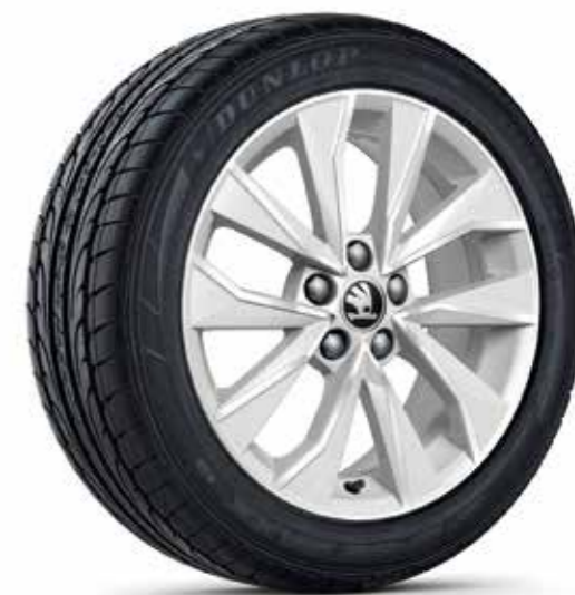
Легкосплавный колёсный диск Italia 7.0J x 16" для шин 215/45 R16 Белый, полированный (6V0 071 496A FM9)
