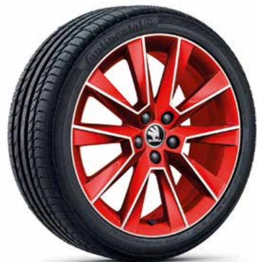
Легкосплавный колёсный диск Savio 7.0J x 17" для шин 215/40 R17 Глянцевый красный, полированный (5JA 071 497E MN4)
