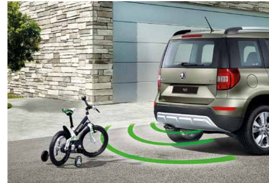
Задние датчики парковки для контроля расстояния между автомобилем и возможными препятствиями. При обнаружении препятствий на расстоянии 140 см от задней части автомобиля система издаёт короткие звуковые сигналы с интервалом в одну секунду. Этот интервал становится короче по мере приближения к препятствию. Как только расстояние уменьшается до 30 см, звуковой сигнал становится непрерывным (BEA 630 001)
