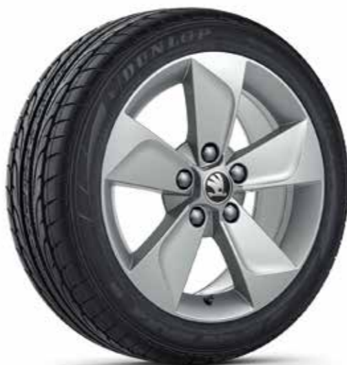
Легкосплавный колёсный диск Nevis 7,0J x 16" для шин 205/55 R16 и 215/60 R16 Серебристый (5L0 071 496A 8Z8)
