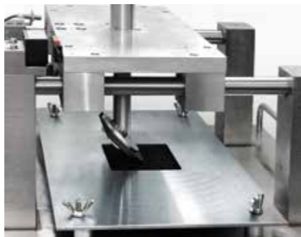
Устройство для «испытания каблуком» Тестирование прочности фиксаторов для ковриков
