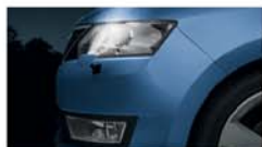
Ксеноновые фары, противотуманные фары с функцией освещения поворотов
