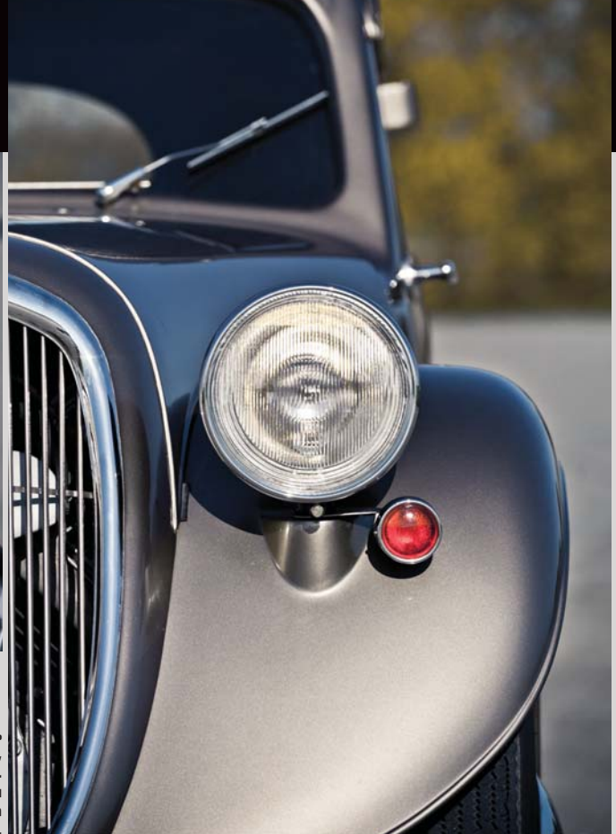
Электрический указатель поворота, разумеется, позднее «наслоение». Иначе автомобилю нельзя было бы выезжать на современные дороги.
