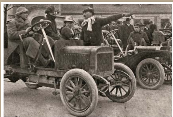
Laurin & Klement FCR по прозвищу Гроб. Автомобиль, специально созданный в 1909 году для участия в соревнованиях. Три передачи, четыре цилиндра, 100 л.с., два экземпляра.
