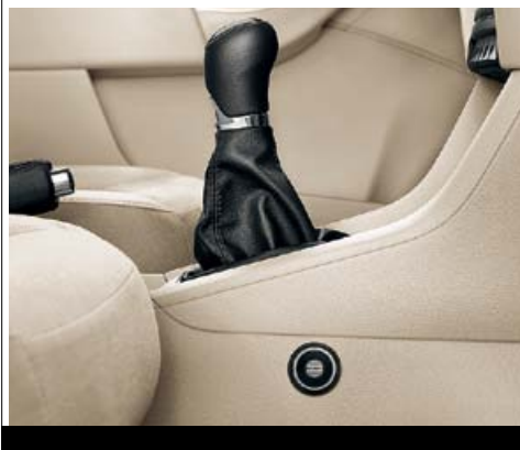
Механический блокиратор коробки передач.*
