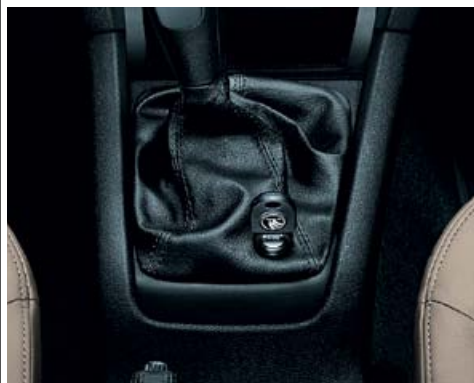
Механический блокиратор коробки передач.*
