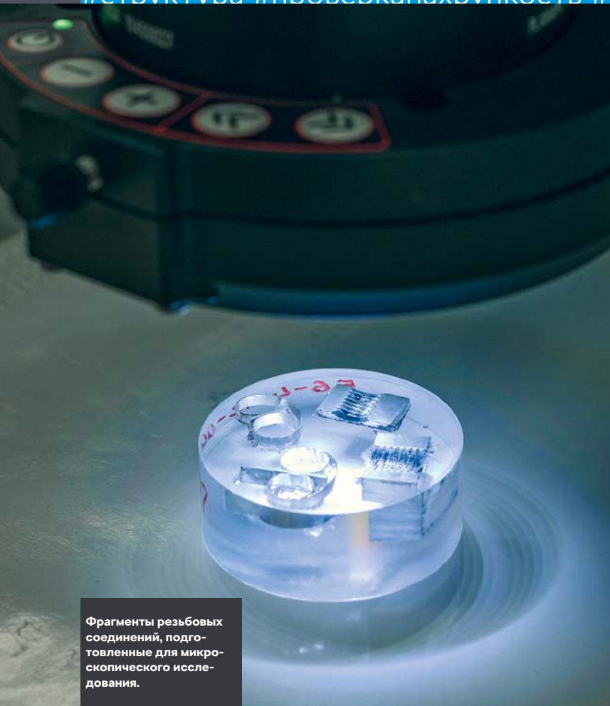
Металлографический диск с очень чистым резом. В лаборатории могут распилить по длине даже коленчатый вал после заковки.
