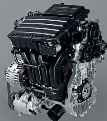
Мотор 1.6 MPI серии EA 211. Разработан в Чехии, выпускается в России.
