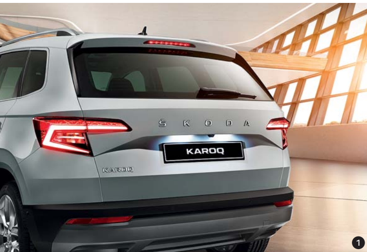
1, 2. Светодиоды повсюду: в задних фонарях, в подсветке номерного знака, в проекторе, высвечивающем приветственный логотип на землю.
